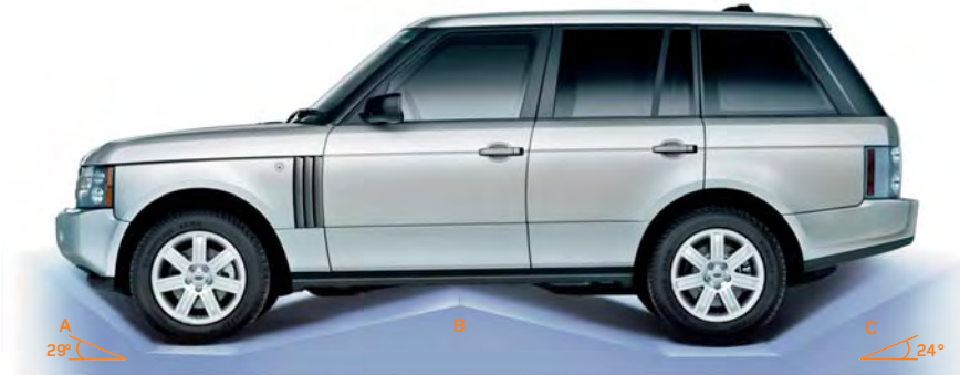
A Angolo di approccio Altezza std 29° Altezza off-road 34° B Angolo di dosso Altezza std 24,4° Altezza off-road 30° C Angolo di uscita Altezza std 24,2° Altezza off-road 26,6°
